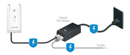
Na imagem acima note que um único cabo de rede desce da roteadora e é então ligado em uma fonte **POE** (esse cabo teria muitos metros se estivéssemos instalando essa antena no topo de uma torre).
